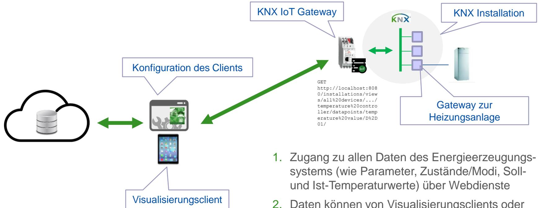
1. Zugang zu allen Daten des Energieerzeugungssystems (wie Parameter, Zustände/Modi, Soll- und Ist-Temperaturwerte) über Webdienste
