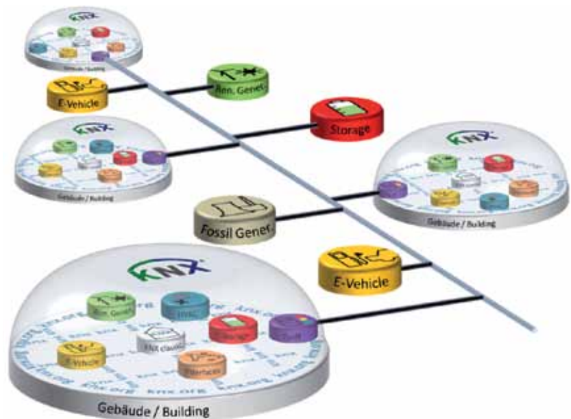
KNX facilita interfaces para la red inteligente. Mediante gestión tarifaria puede poner KNX las cargas de un edificio en armonía con la generación de energía renovable de toda una ciudad.
