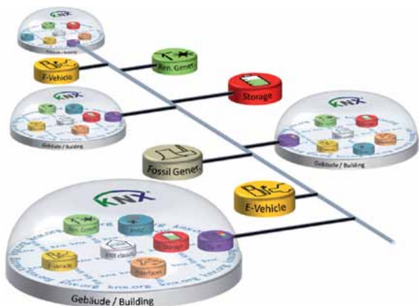
KNX предоставляет интерфейс для интеллектуальной сети «Smartgrid». С такими методами, как управление тарифами, KNX может превосходно соотносить нагрузку/потребление в зданиях с возобновляемой энергией, вырабатываемой для всего участка
