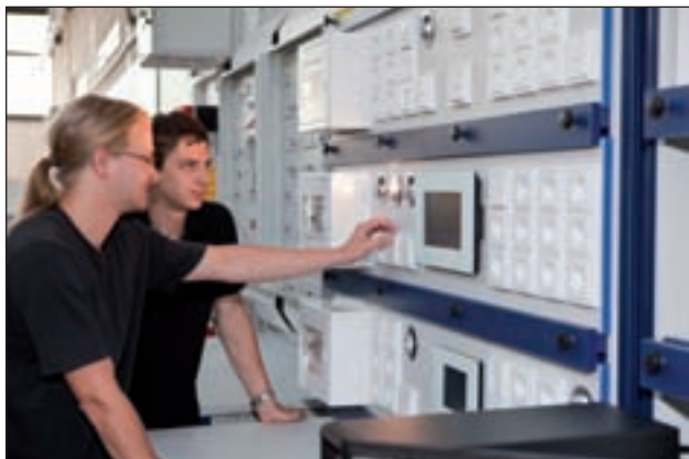
在测试台上的触摸屏说明负载管理功能是否符合要求
