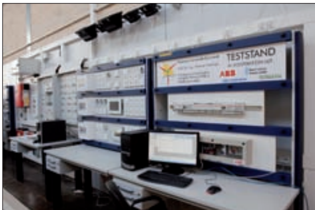
在KNX测试台上，学生可以像在家中一样使用ETS设置和测试功能
