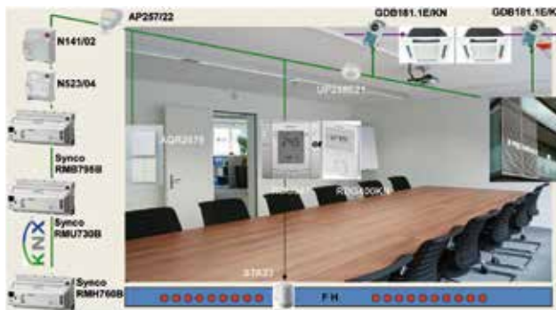
Een optimaal ruimtecomfort dankzij de integratie van HVAC en verlichting. / Un confort optimal de la pièce grâce à l'intégration des systèmes HVAC et d'éclairage.
