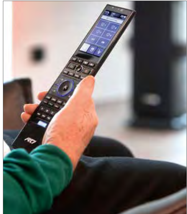
Eine Funkfernbedienung kann alle Haus-, Multimedia- und Sicherheitsfunktionen steuern.
