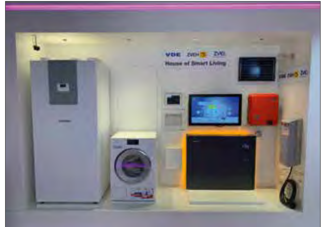
HLK, Waschmaschine mit WLAN-Verbindung, Stromspeicher und Ladebereich
