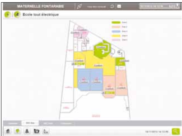
Visualisierung mit Grundriss: Über das Gebäudemanagement können in die Funktionszustände aller Standorte eingesehen werden.
