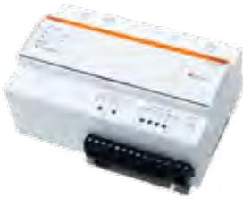
Das System Equobox\_Master Solution wird zur Messung des Energieverbrauchs sowie anderer Werte in Gebäuden verwendet und baut auf der EQUOBOX CPU auf. Dieser Web-Server erfasst Daten, die von Geräten wie LEVEL CONVERTER oder RTU bzw. von Modbus-Geräten stammen und erstellt daraus detaillierte Berichte. Auch eine grafische Analyse ist möglich. Das Gateway hat Funktionen für den Datenaustausch mit verschiedenen Feldbussen (KNX, RS485, M-BUS). Die Hauptfunktionen:
