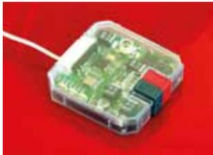
Der neue RF Medienkoppler von TAPKO – basierend auf dem 2.0 Modell – ist das zweite Gerät der Kopplerserie, das die Möglichkeit hat, per Tastendruck die Telegrafmfilterung vorübergehend auszuschalten und somit die Inbetriebnahme der Anlage erleichtert.
