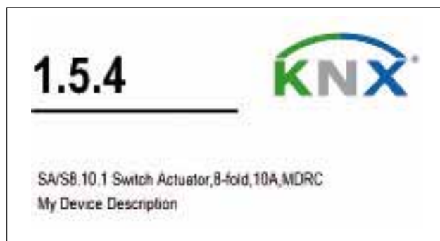
Mit der ETS App „Etiketten“ lassen sich auf Basis von Zweckformaufklebern Etiketten ausdrucken. Dabei werden die Informationen direkt aus der ETS4 übernommen.
