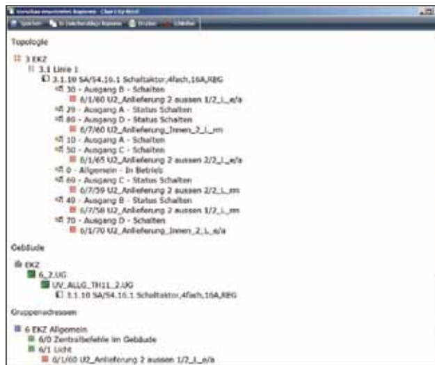
Die neuen ETS Apps von KNX machen mehr aus der ETS4: Zum Beispiel die Zusatzfunktion „Erweitertes Kopieren“, mit der sich auf einfache Art und Weise Projektteile markieren, duplizieren, dem Kopierziel anpassen und in weitere Gebäudeteile einfügen lassen.
