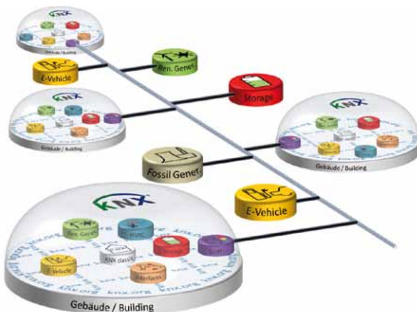
KNX ermöglicht Schnittstellen zum intelligenten Stromnetz. Durch z.B. Tarifmanagement kann KNX Gebäudelasten in optimalen Einklang zur regenerativen Erzeugung in einem ganzen Gebiet bringen.
