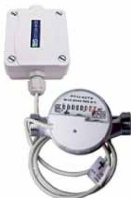
Il contatore d'acqua residenziale è una combinazione del contatore calibrato 'Modularis WZ-M' da NZR e l'unità di conteggio di impulsi SK01-IMPZ1 da Arcus-EDS GmbH. La seconda include la memorizzazione di dati con batteria tampone e una unità di accoppiamento al bus KNX. In questo modo, il prodotto può essere usato per la lettura e il monitoraggio remoto.
