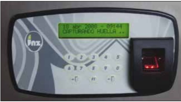
Figur 4. Takket være grensesnittet for adgangssystem (fingeravtrykk) til KNX-systemet, er et kundetilpasset system og kontroll mulig.
