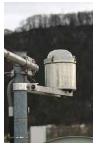
2. ábra. Fényérzékelőt tartalmazó fűtött mérőfej. Forrás: Schäcke
