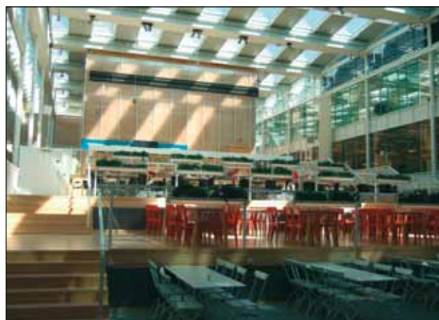
3. ábra. A világítóudvar mesterséges és nappali fénye távvezérléssel állítható az aktuális igény szintnek megfelelően. Forrás: Energoretea
