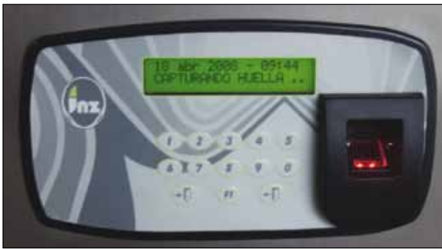
4. ábra. A KNX berendezés beléptetés-ellenőrző interfészének (ujjlenyomat) köszönhetően lehetséges az összes berendezés igényeknek megfelelő vezérlése és szabályozása. Forrás: ZVG
