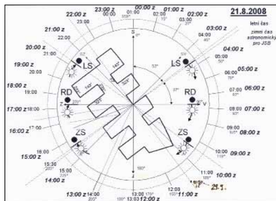
Protection solaire exactement selon la routine quotidienne: schéma de contrôle astro
