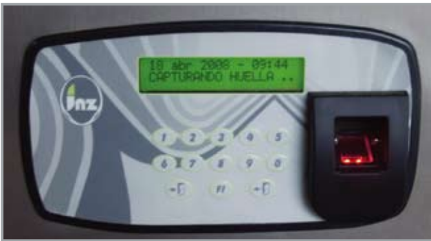
图4. 归功于KNX系统的访问控制系统（指纹）界面，对所有系统进行定制控制成为可能
