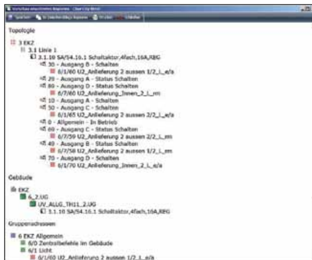
Nieuwe ETS Apps van KNX maken ETS4 aantrekkelijker: bijvoorbeeld met de „Extended Copy“ applicatie kunnen gebruikers makkelijk elementen van bestaande projecten selecteren en kopiëren. De doelkopie kan dan worden aangepast in andere delen van het gebouw.
